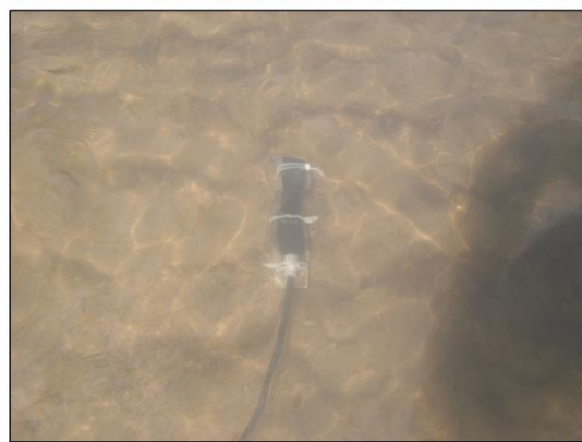
B: AV sensor on stream bottom
