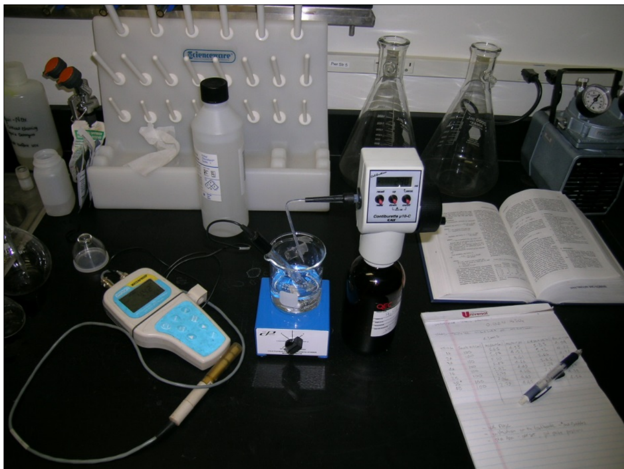
Figure SOP4-2. Apparatus setup for Gran titration.
